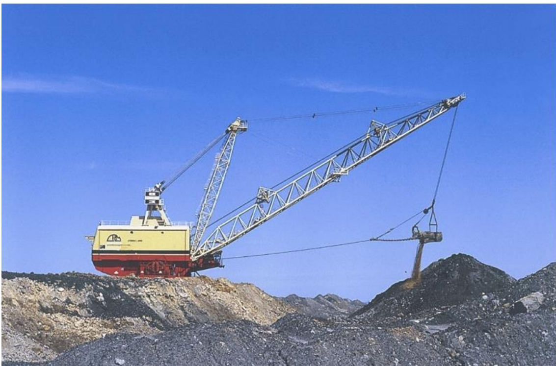
Figura 7: Draga de arraste elétrica utilizada para remover o material fragmentado durante o desmorte (CRM, 2017).
