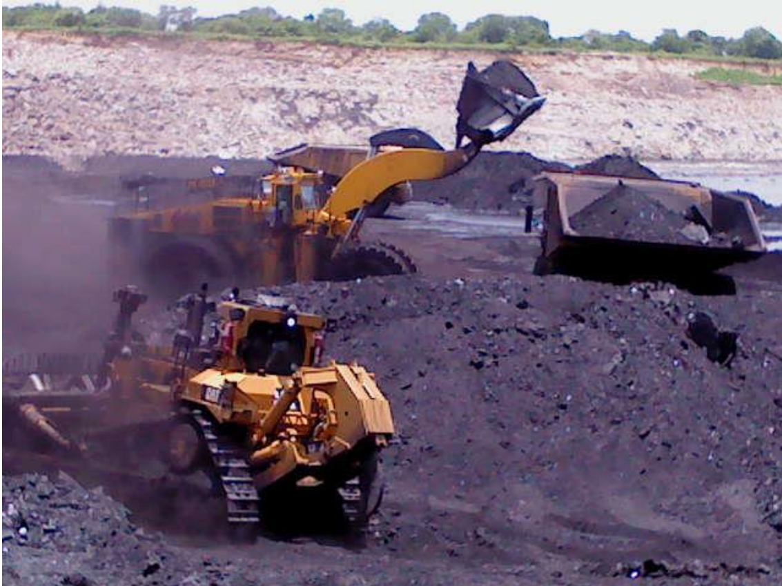
Figura 10: Utilização de tratores de esteira e escavadeiras para desmonte mecânico na mina de Moatize (Mambo, 2017).
