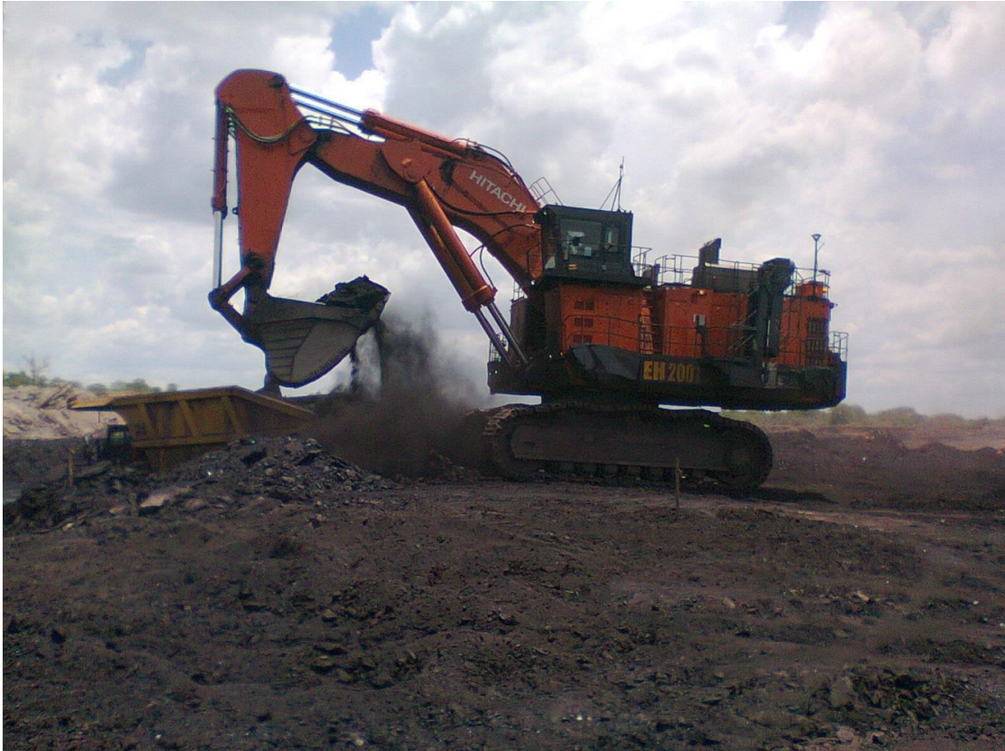
Figura 11: Retro-escavadeira hidráulica utilizada para o carregamento do material fragmentado (Mambo, 2017).
